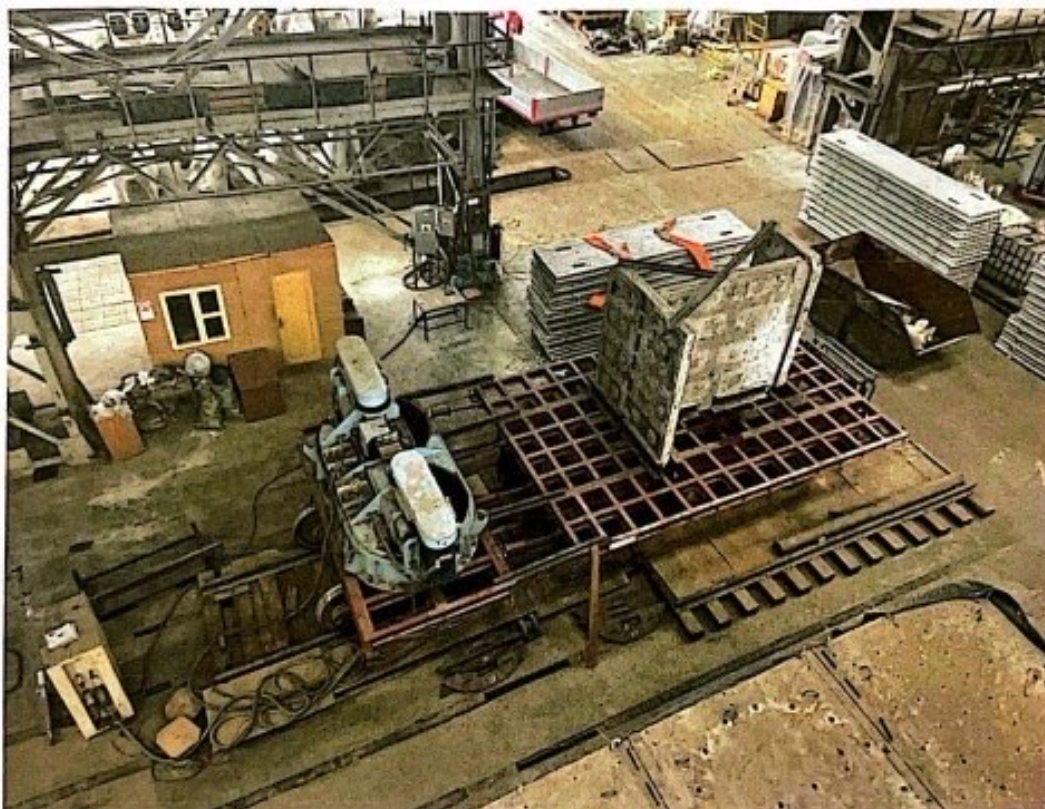
Рисунок 1.1 Общий вид виброплатформы инерционного действия.
