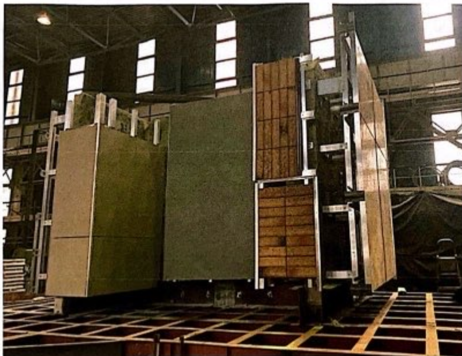
Рисунок 4.1 Общий вид экспериментального стенда после установки на виброплатформу.
